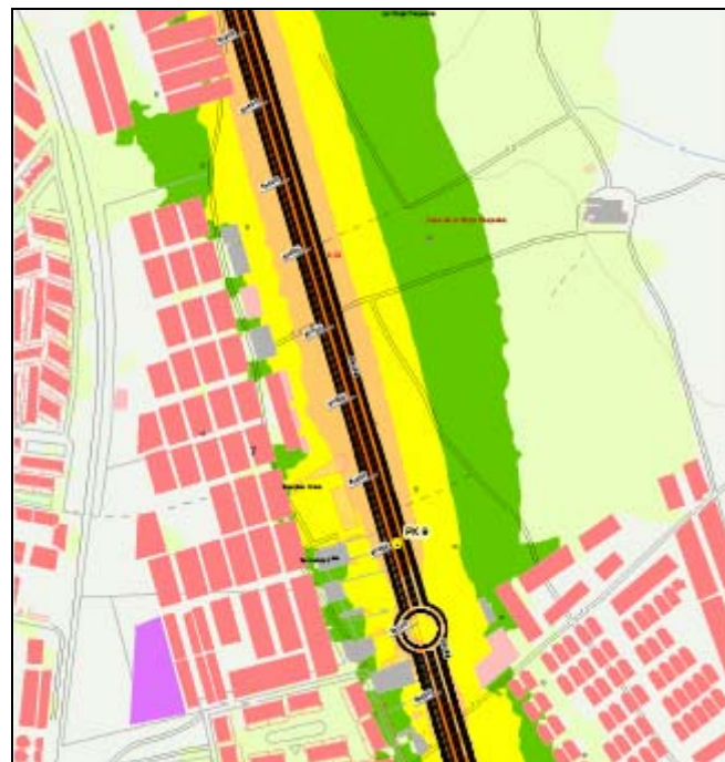
Ilustración 59. Tramo 7 de estudio de la carretera CV-905, con los niveles de ruido Lnoche dB(A) reflejado según la leyenda de colores.
