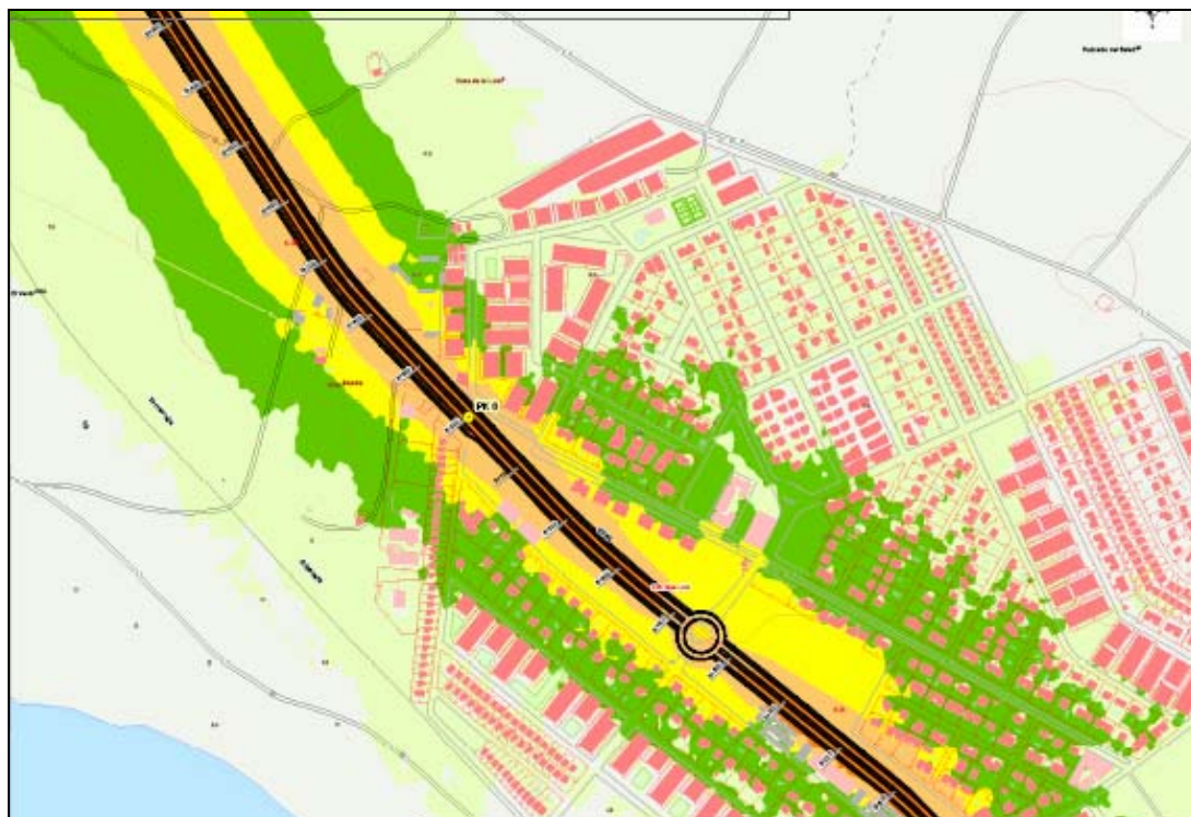
Ilustración 54. Tramo 5 de estudio de la carretera CV-905, con los niveles de ruido Lnoche dB(A) reflejado según la leyenda de colores.
