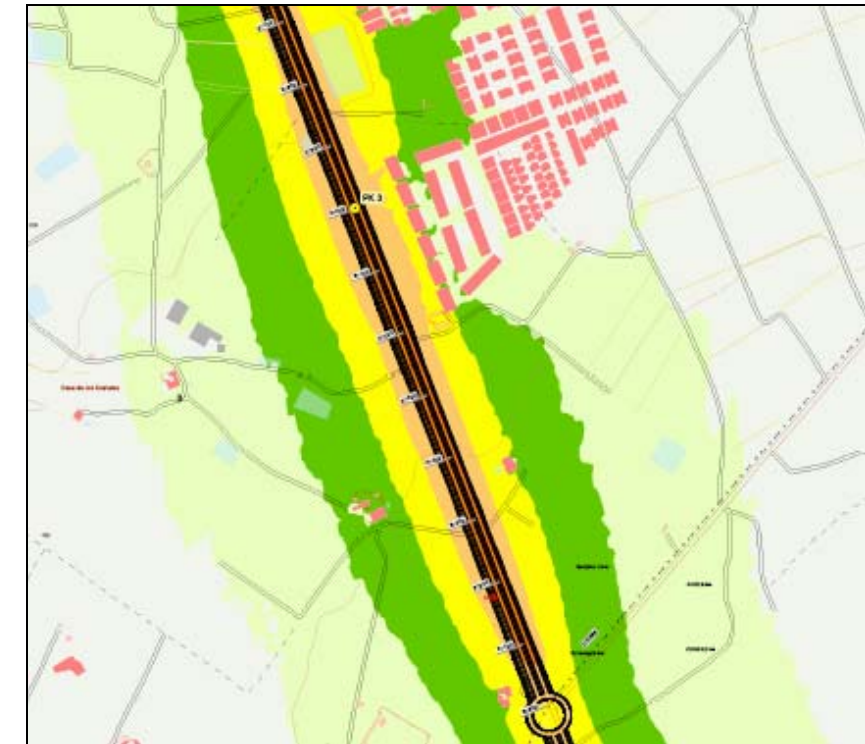
Ilustración 49. Tramo 3 de estudio de la carretera CV-905, con los niveles de ruido Lnoche dB(A) reflejado según la leyenda de colores.
